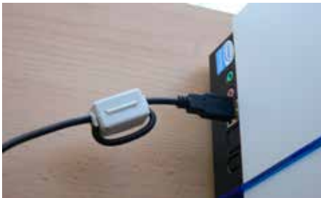
Klappkern auf dem USB-Kabel am Computer
