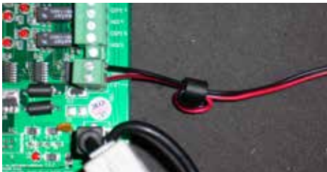
Ferrithülse auf dem Stromversorgungskabel
