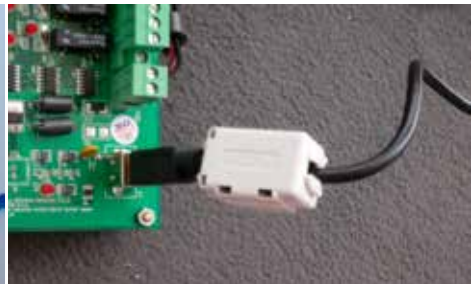
Klappkern auf dem USB-Kabel am USB-IO 1 oder 2 x durch den Kern geführt
