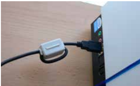
Klappkern auf dem USB-Kabel am Computer
